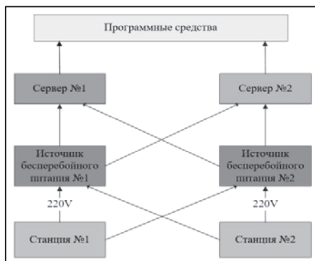
Рис. 1. Схема системы бесперебойного питания
