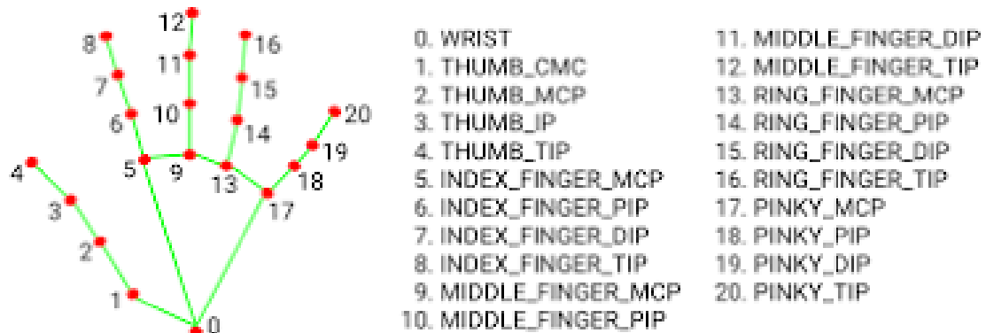
Рисунок 1 – Біомеханічна оцінка рухових порушень рук за ключовими точками віртуального скелета кисті на базі технології комп'ютерного зору
